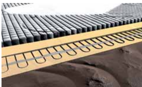
▲ Podjazd odlodzony (odsnieżony) matą, dwa ślady pod koła samochodu
