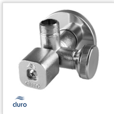
CLURO, Zawory kątowe antykamienne z filtrem SOLID. Zastosowanie: instalacje wodociągowe. Zalety: metalowe pokrętko, filtry antykamienne, zawór może pełnić funkcję „prawego” lub „lewego” w zależności od miejsca zamontowania adaptera i odpowiedniego obrócenia zaworu.
