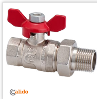
CALIDO, Zawory kulowe SERIA 530. Zastosowanie: instalacje centralnego ogrzewania, instalacje dystrybucji wody pitnej, systemy pneumatyczne i olejowe. Zalety: korpus odkuwany z mosiądzu CW617N, dźwignia stalowa z powłoką antykorozyjną (GEOMET/epoxyd), uszczelnienie dynamiczne trzpienia. Zawory posiadają certyfikat CE i są zgodne z Dyrektywą Unijną 97/23/CE.
