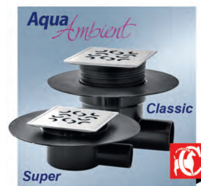
CAPRICORN, łazienkowe wpusty punktowe Aqua Ambient. Typ: dostępne w wersji Classic (przepływ 48 l/min) – uniwersalne do każdego typu pomieszczeń; dedykowane do średnicy rur Ø50 oraz Super (przepływ 21 l/min) – zaprojektowanej specjalnie dla pomieszczeń z ograniczeniami w wysokości posadzki; dedykowane do średnicy rur Ø50 lub Ø40. Materiał: korpus: polipropylen, kratka: stal nierdzewna.
