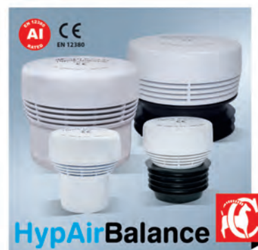
CAPRICORN, Zasuw napowietrzające HypAir Balance. Typ: MaxiHab \varnothing 110 (przepływ 25,4 l/s) oraz \varnothing 70 -110 MiniHab \varnothing 50 (przepływ 7,6 l/s) oraz \varnothing 32 -63. Cechy szczególne: zgodne z normą EN 12380, posiadają najwyższą klasę A1 dopuszczającą ich instalację poniżej poziomu zalewania oraz umożliwiającą działanie w temperaturze w zakresie od -20 do +60°C. Materiał: ABS.
