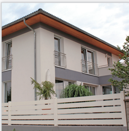
Guardi-O.B.A., Ogrodzenie posesyjne – model Triest. Konstrukcja: ogrodzenie z lat aluminiowych o przekroju 150x19 w układzie poziomym, osadzonych w pionowym profilu U. Odstęp między latami ok. 40 mm. Wykończenie: lakierowane proszkowo. Wymiary: na zamówienie.
