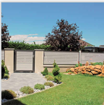
Guardi-O.B.A., Ogrodzenie posesyjne – model Nouveau. Konstrukcja: ogrodzenie z lat aluminiowych o przekroju 78x19 w układzie poziomym osadzonych w pionowym profilu U. Odstęp między latami ok. 15 mm. Wykończenie: lakierowane proszkowo. Wymiary: na zamówienie.
