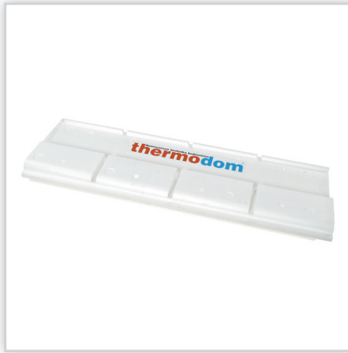
Thermodom, System dachowy TH7. Energooszczędny, nakrokwiowy system dachowy. Eliminuje konieczność stosowania lat, kontrłat, wełny mineralnej i folii. Kryty dachówką betonową lub ceramiczną. Doskonały współczynnik przenikania ciepła U_0 [W/m 2 K]: <0,23. Aprobaty: Europejska Aprobata Techniczna. Cena netto [zł/m 2 ]: 94.
