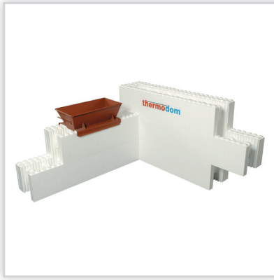
Thermodom, System ścienny TH300. Elementy do wznoszenia ciepłych ścian budynków energooszczędnych i pasywnych oraz ścian fundamentowych. Doskonały współczynnik przenikania ciepła U_0 [W/m 2 K]: <0,20. Grubość ścian [cm]: 30. Zużycie betonu [m 3 /m 2 ]: 0,122. Aprobaty: Europejska Aprobata Techniczna. Cena netto [zł/m 2 ]: 130.
