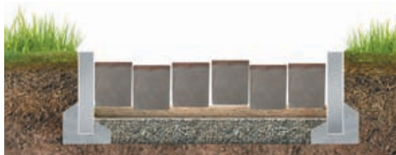
niewłaściwe ułożenie kostek
