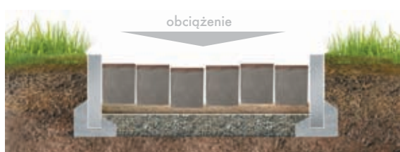
niewłaściwe ułożenie kostek
