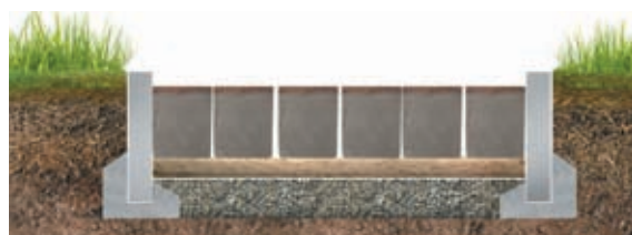
niewłaściwe ułożenie kostek
