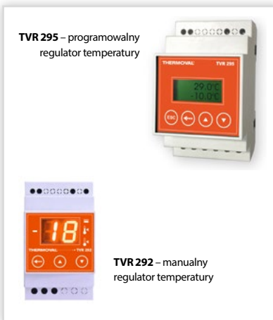
TVR 292/TVR 295 – manualny/programowalny regulator temperatury. WTVR 295 wbudowany programator i wyłącznik – 2 przebieżniki, współpracuje z 2 czujnikami, przebieżnik 2x16 A (3600 W). Regulacja temp.: od -29 do +60°C (TVR 292), od -29 do +90°C (TVR 295). Stopień ochrony: IP 20. Zasilanie [V]: 230. Montaż: szynie DIN. Zastosowanie: sterowanie (jednostrefowe – TVR 292; dwustrefowe – TVR 295) systemami ogrzewania, które są instalowane w podłożu, w rynnach, na dachach, rurach.
