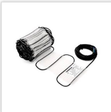
Mata grzejna TV AFS. Moc [W/m 2 ]: 300. Zastosowanie: ogrzewanie nawierzchni schodów. Pow.: 1,2-3,6 m 2 . Dł.: 4-12 mb. Szer.: 0,3 m. Gr.: 4,8 mm. Moc całkowita [W]: 360-1080. Zasilanie: ~ 230 V – jednostronne. Dł. przewodów zasilających: 4 mb.
