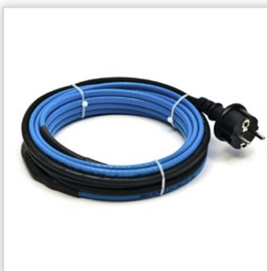
Przewód grzejny TVS 10 – samoregulujący. Moc [W/mb]: 10. Zastosowanie: ogrzewanie instalacji rurowych. dł.: 2-35 mb. gr.: 7,0 mm, moc całkowita 20 - 350 W. Zasilanie: ~ 230 V – jednostronne. Dł. przewodów zasilających: 2 mb, wyposażone w wtyczkę.
