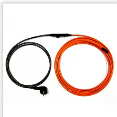
Przewód grzejny TV Thermo switch – stałoporowy. Moc [W/mb]: 17. Zastosowanie: ogrzewanie instalacji rurowych. Dł.: 2-49 mb. Gr.: 7,0 mm. Moc całkowita [W]: 34-833. Zasilanie: ~ 230 V – jednostronne. Dł. przewodów zasilających: 2 mb, wyposażone w wtyczkę, wbudowany bimetaliczny wyłącznik/wyłącznik.
