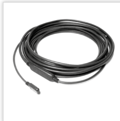
Przewód grzejny TV SHTL – stałoporowy. Moc [W/mb]: 20 i 30. Zastosowanie: ogrzewanie rynien, rur spustowych, dachów, nawierzchni. Dł.: 6-175 mb. Gr.: 7,0 mm. Moc całkowita [W]: 150-4800. Zasilanie: ~ 230 V – jednostronne. Dł. przewodów zasilających: 4 mb.
