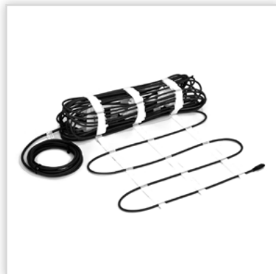
Mata grzejna TV HMO. Moc [W/m 2 ]: 300. Zastosowanie: ogrzewanie nawierzchni. Pow.: 1-16 m 2 . Dł.: 2-32 mb. Szer.: 0,5 m. Gr.: 6,1 mm. Moc całkowita [W]: 300-4800. Zasilanie: ~ 230V – jednostronne. Dł. przewodów zasilających: 2 mb.
