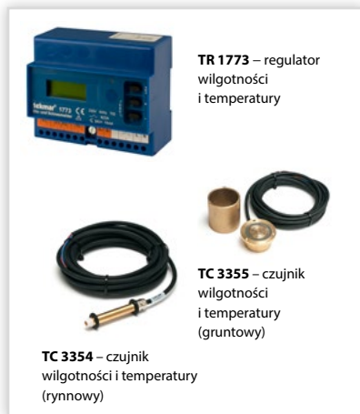
TR 1773 – programowalny regulator temperatury i wilgotności. Współpracujący z hybrydowymi czujnikami TC 3354 i TC 3355, przebieżnik 16 A (3600 W). Stopień ochrony: IP 20. Zasilanie [V]: 230. Montaż: na szynie DIN. Zastosowanie: sterowanie systemami ogrzewania, które są instalowane w nawierzchniach gruntowych, w rynnach, na dachach, rurach.
