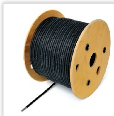
Przewód samoregulujący ELSR. Moc [W/mb]: 10, 15, 20, 25, 30, 40, 50. Zastosowanie: ogrzewanie nawierzchni, rynien, rur spustowych, dachów, instalacji rurowych. Gr.: od 12,80/4,60 do 17,20/9,50 mm. Moc całkowita [W]: 10-5000. Zasilanie: ~ 230 V – jednostronne.
