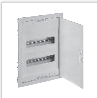
Legrand, RWN – rozdzielnice węgłkowe o szerokości 12 modułów z drzwiami metalowymi w kolorze białym w komplecie. Stopień ochrony: IP40 – IK07 z drzwiami. Znamionowe napięcie pracy: 400 V AC – 50/60 Hz. Izolacyjność: II klasa ochronności.
