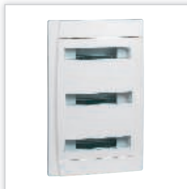
Legrand, Practibox – rozdzielnice węgłkowe o szerokości 12 modułów z drzwiami półprzezroczystymi w komplecie. Stopień ochrony: IP40 – IK07 z drzwiami. Znamionowe napięcie pracy: 400 V AC – 50/60 Hz. Izolacyjność: II klasa ochronności.
