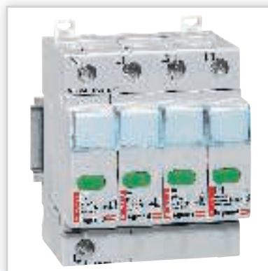
Legrand, Ochronniki przeciwprzepięciowe ON300 – typ 1 (klasa B), typ 2 (klasa C), typ 1+2 (klasa B+C); poziomy ochrony do 1,2 kV; rozwiązania jedno-, dwu-, trzy- i czterobiegunowe; wymienne wkłady do ochronników.
