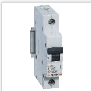
Legrand, Wyłączniki nadprądowe RX 3 – rozwiązania jedno- i trójbiegunowe; zdolność zwarciova 6000 A (zgodnie z normą EN 60898-1); charakterystyki B i C; prądowy znamionowy 10, 16, 20 i 25 A.
