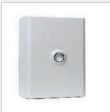
Legrand, Drivia – rozdzielnice naścienne 13 modułów z drzwiami przezroczystymi lub białymi, zamawianymi osobno. Stopień ochrony: IP40 – IK07 z drzwiami. Znamionowe napięcie pracy: 400 V AC – 50/60 Hz. Izolacyjność: II klasa ochronności.
