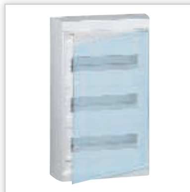
Legrand, Nedbox – rozdzielnice naścienne o szerokości 12 modułów z drzwiami przezroczystymi lub białymi w komplecie. Stopień ochrony: IP40 – IK07 z drzwiami. Znamionowe napięcie pracy: 400 V AC – 50/60 Hz. Izolacyjność: II klasa ochronności.
