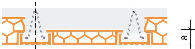
Rys. 20 Uzupełniający pustak stropowy Porotherm 8/50
