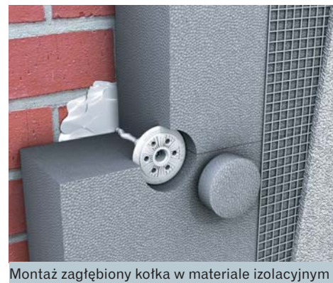
Montaż zagłębiony kołka w materiale izolacyjnym
