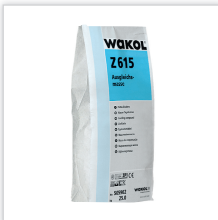
Wakol GmbH, WAKOL Z 615 masa wyrównawcza, niskopyląca . Cementowa masa wyrównawcza do wyrównywania nierówności warstwami o grubości od 1 do 40 mm, pod wykładziny tekstylne, elastyczne i parkiet. Stosowanie wewnątrz pomieszczeń. Zużycie: 1,0-1,5 kg/mm grubości.
