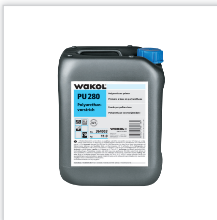
Wakol GmbH, WAKOL PU 280 Gruntówka poliuretanowa . Uniwersalny w zastosowaniu produkt: blokuje wilgoć, wzmacnia słabe podłoże, wiąże pozostałości starych klejów. Kolejny etap prac możliwy po 40-50 minutach. Do stosowania na podłożu z ogrzewaniem podłogowym Zużycie: 100-350 g/m 2 .
