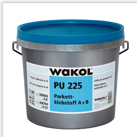
Wakol GmbH, WAKOL PU 225 Klej do parkietu . Dwuskładnikowy klej poliuretanowy do bezprzesuwnej klejenia na chłonnych i niechłonnych podłożach parkietu litego i mozaikowego, mozaiki przemysłowej, lamelek, parkietu wielowarstwowego, desek litej, kostki brukowej z drewna RE/WE. Nie zawiera rozpuszczalników, można stosować na podłożu z wbudowanym ogrzewaniem podłogowym. Zużycie: 800-1300 g/m 2 .
