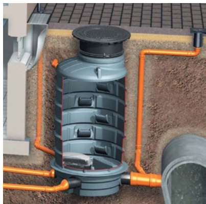
Przydomowa studzienka przeciwzalewowa z polietylenu wyposażona w zawór zwrotny z pompą Pumpfix F
