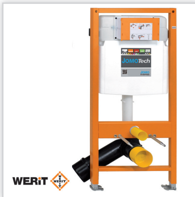
WERIT, STELAŻ PODTYNKOWY WC JOMO TECH Zastosowanie: stelaż daje możliwość instalacji urządzeń sanitarnych przy ścianach murowanych oraz lekkich ściankach działowych. Zalety: nowy, wielofunkcyjny uchwyt ścienny, bezstopniowa regulacja trawersów poprzecznych, oznaczenie wysokości montażowej, sprawdzone bezpieczeństwo TÜV, montaż szyny na izolacji akustycznej.
