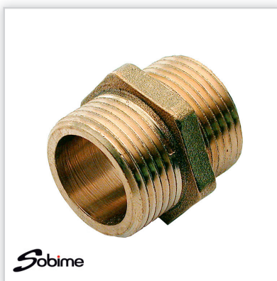
SOBIME, ŁĄCZNIKI MOSIĄDZOWE GWINTOWANE I DO WLUTOWANIA Zalety: mosiądz nietoksyczny, zgodny z normami europejskimi: EN-12165 oraz EN-1982, wymiary od 1" do 4", śrutowane – wzmocnione powierzchnie, gratowane gwinty. Pozostała oferta: zawory czerpalne grzybkowe, zawory antyskażeniowe i zawory zwrotne GZ/GZ.
