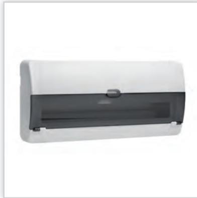
Nedbox BX – rozdzielnie ściennie, jednorzędowe o 12, 16 lub 22 modułach z drzwiami przezroczystymi lub białymi. Stopień ochrony: IP30 – IK07 z drzwiami. Znamionowe napięcie pracy: 400 V AC – 50/60 Hz. Izolacyjność: II klasa ochronności.
