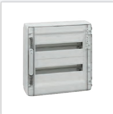
XL 3 125 – rozdzielnie ściennie o szerokości 18 modułów z drzwiami przezroczystymi lub białymi w komplecie. Stopień ochrony: IP40 – IK09 z drzwiami. Znamionowe napięcie pracy: 400 V AC – 50/60 Hz. Izolacyjność: II klasa ochronności.
