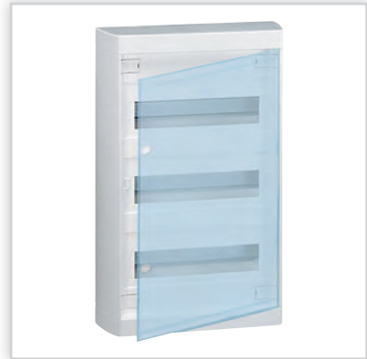
Nedbox – rozdzielnie ściennie o szerokości 12 modułów z drzwiami przezroczystymi lub białymi w komplecie. Stopień ochrony: IP40 – IK07 z drzwiami. Znamionowe napięcie pracy: 400 V AC – 50/60 Hz. Izolacyjność: II klasa ochronności.
