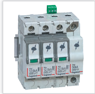
Ograniczniki przepięć ON300 – typ 1 (klasa B), typ 2 (klasa C), typ 1+2 (klasa B+C); poziom ochrony do 1,2 kV; rozwiązania 1P, 1P+N, 2P, 3P, 3P+N i 4P; wymienne wkłady do ochronników.
