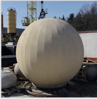
Produkty na specjalne zamówienie. Na zdjęciu betonowa kula o średnicy 3,5 m spełniająca rolę zbiornika naziemnego.
