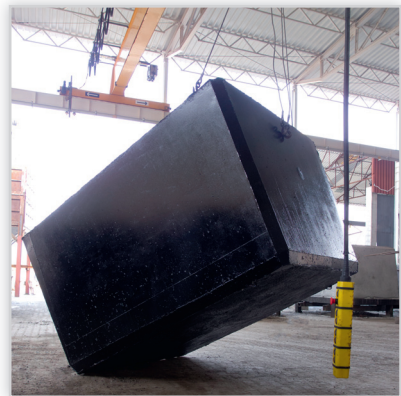
Zbiornik bezodpływowy 7 m. Charakterystyka: zbiornik żelbetowy, ściany i dno są produkowane jako monolit w pozycji odwróconej; produkcja odbywa się wyłącznie pod dachem; proces odwrócenia zbiornika gwarantuje jakość konstrukcji; producent zawsze podaje pojemność czynną zbiornika. Cena netto [zł]: 1990.
