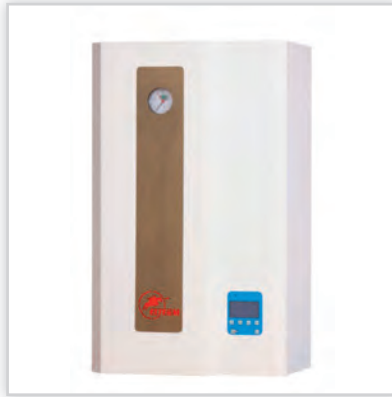
Seria GoldLine, elektryczny kocioł centralnego ogrzewania „General”. Kocioł dwufunkcyjny do pracy samodzielnej, zabudowane naczynie przeponowe c.o. 8 l, 2 pompy c.o./c.w.u. oraz armatura hydrauliczna; sterowanie pogodowe, wyświetlacz LCD; wbudowane programowanie tygodniowe oraz programowanie c.w.u. Moce [kW]: 4-24. Waga [kg]: 28. Wymiary (wys./szer./gł.) [cm]: 68/41/27. Cena katalogowa netto [zł]: od 3280.
