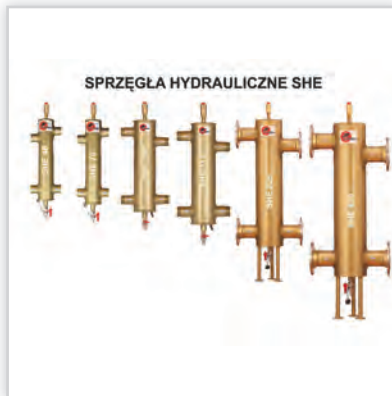
Sprzęgła hydrauliczne nieocieplane. Do 30% dłuższa żywotność kotła dzięki skutecznej ochronie przed niską temp. wody powrotnej. Zwiększenie komfortu użytkownika dzięki wykorzystaniu odmulania oraz odpowietrzania układu. Do 30% dłuższa żywotność pomp za sprawą wzajemnego niezakłócenia pracy. 100% kontrola ciśnienia. Moce [kW]: 40-750. Przyłącza: od 1" do 5". Cena katalogowa netto [zł]: od 310.
