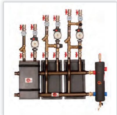
Zestaw hydrauliczny ELTERM. W ofercie produktów firmy Elterm znajdują Państwo także 2- i 3-drogowe kolektory rozdzielające kompatybilne ze sprzęgłami hydraulicznymi lub do samodzielnego wykorzystania, które występują także w wersji ocieplonej. Zestaw można wyposażyć dodatkowo w szereg grup pompowych. Produkty wykonane są z grubościenniej stali, solidnie spawane metodą MAG i poddawane 100% kontroli jakościowej.
