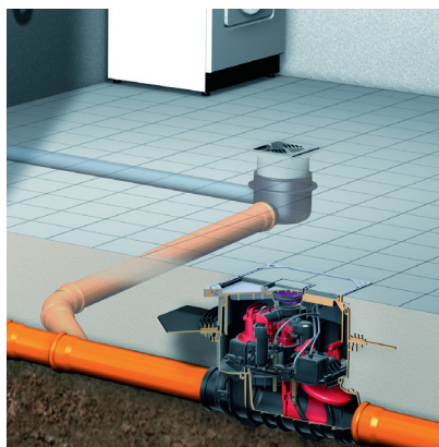
Przykład zabudowy zaworu Pumpfix F Komfort
