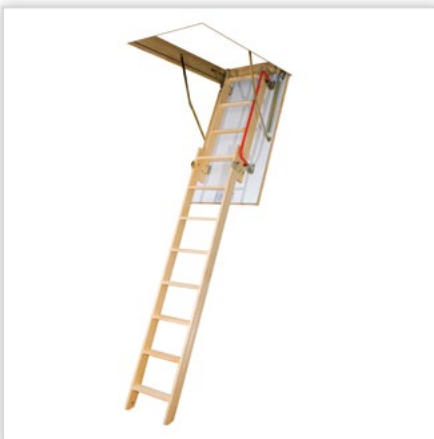
Schody LDK wysuwane. Wyposażenie: biała klapa termoizolacyjna, poręcz, wysuwany segment. Cechy szczególne: wysoki komfort użytkowania. Maks. wys. pomieszczenia [cm]: 280, 300 i 335. Maks. dopuszczalne obciążenie [kg]: 160. Izolacja termiczna [cm]: 3.
