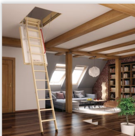
Schody LWT. Wyposażenie: biała klapa termoizolacyjna, poręcz, plastikowe stopki. Cechy szczególne: wysoki komfort użytkowania, doskonałe parametry termoizolacyjne, prosty montaż i demontaż klapy. Maks. wys. pomieszczenia [cm]: 280 i 305. Maks. dopuszczalne obciążenie [kg]: 160. Izolacja termiczna [cm]: 7,4.
