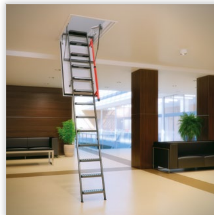
Schody LMF. Wyposażenie: biała klapa ognioodporna, mechanizm odciążający drabinkę w poręcz, wysuwane stopki, stalowa skrzynka, system szybkiego montażu, metalowe listwy wykończeniowe. Cechy szczególne: klasa odporności ogniowej EI 1 =120 min. Maks. wys. pomieszczenia [cm]: 280 i 305. Maks. dop. obciążenie [kg]: 200. Izolacja termiczna [cm]: 8.
