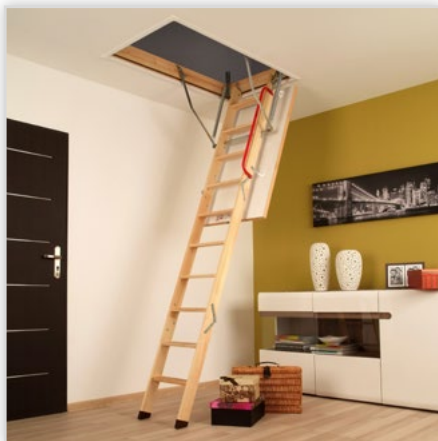
Schody LWS Plus/LWK Plus. Wyposażenie: LWS Plus – beżowa klapa termoizolacyjna, LWK Plus – biała klapa termoizolacyjna, poręcz, plastikowe stopki. Cechy szczególne: prosty montaż i demontaż klapy, innowacyjne rozwiązania konstrukcyjne dla większego komfortu i bezpieczeństwa. Maks. wys. pomieszczenia [cm]: 280 i 305. Maks. dopuszczalne obciążenie [kg]: 160. Izolacja termiczna [cm]: 3.
