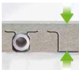
Nieznaczne zwiększenie wysokości podłogi - od 17 mm, system idealny do renowacji.
