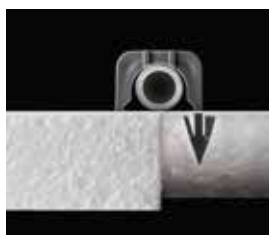
Nieznaczne podniesienie rury dzięki zastosowaniu spinek x-net C12
