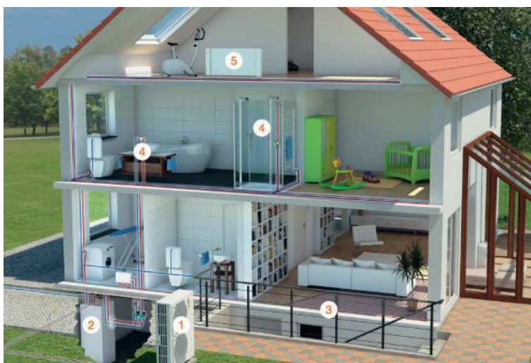
Zasobnik c.w.u. (po lewej) i system Ecodan: 1) pompa ciepła ZUBADAN, 2) zasobnik wody pitnej, 3) ogrzewanie podłogowe, 4) punkty dostarczania ciepłej wody, 5) kaloryfer
