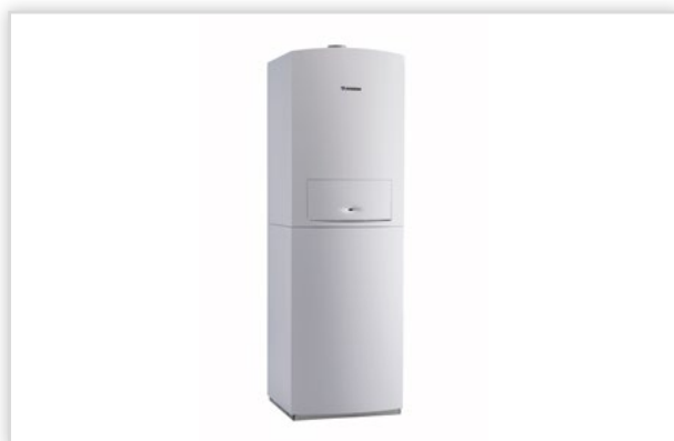
Cerapur Modul ZBS... – kondensacyjne gazowe stojące kotły ze zintegrowanymi zasobnikami warstwowymi c.w.u. Moce cieplne [kW]: c.o. do 14, 22 lub 31; c.w.u. do 16, 28 lub 30; modulacja od 2,9 kW. Sprawność [%]: do 110. Zalety: wysoki komfort c.w.u. – do 36 l/min, funkcja Solar ControlUnit Inside – optymalizacja zysków solarnych, optymalizacja kondensacji – zintegrowany system współpracy czujnika temp. powrotu c.o. z pompą c.o.
