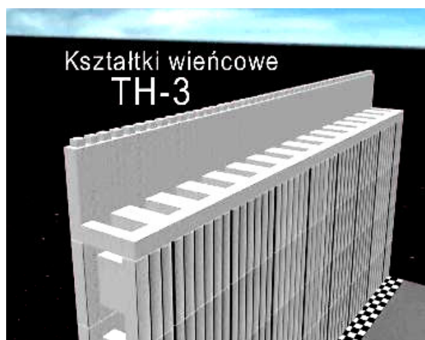
Rys. 36 Układanie elementów wieńcowych TH-3
