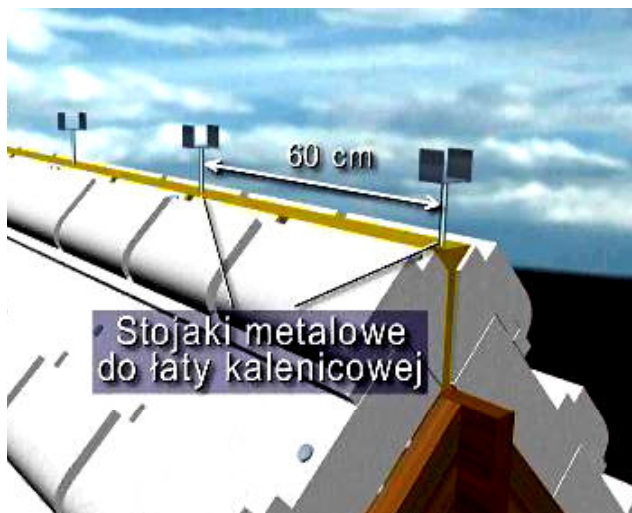
Rys. 83 Montaż metalowych stojaków pod łątę kalenicową
