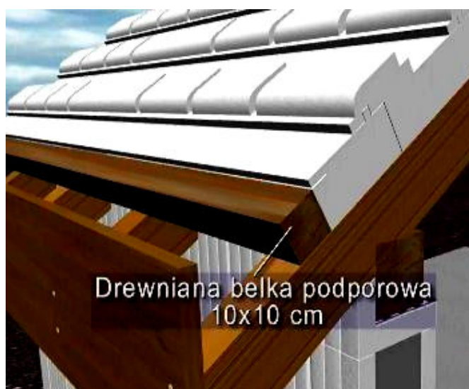
Rys.68 Przybicie belki oporowej
