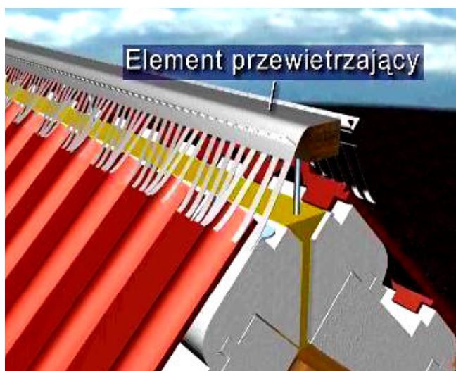
Rys.85 Montaż elementu przewietrzającego
