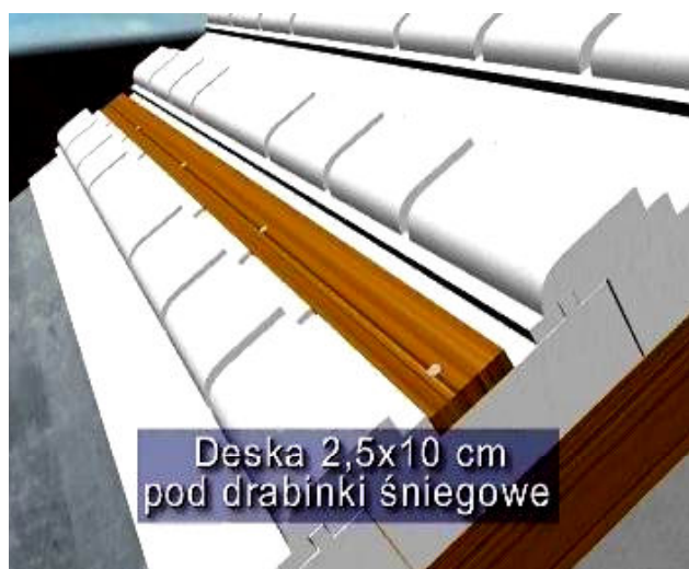
Rys.71 Montaż deski pod drabinki śniegowe
