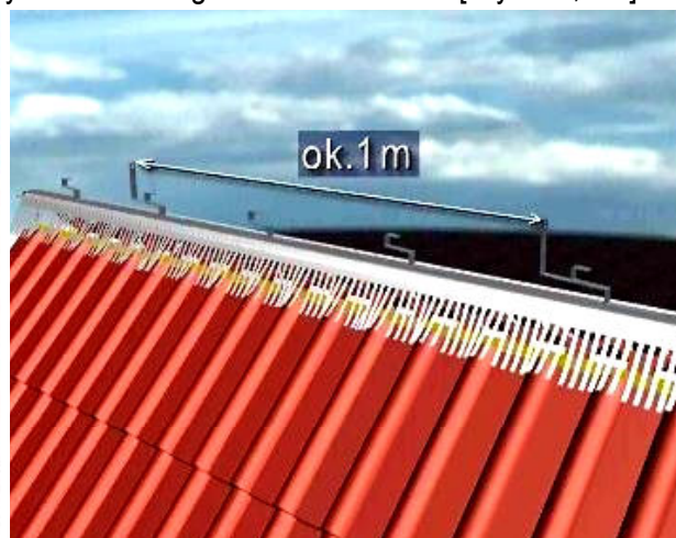
Rys.87 Montaż łapek pod gąsior i odgromienie
