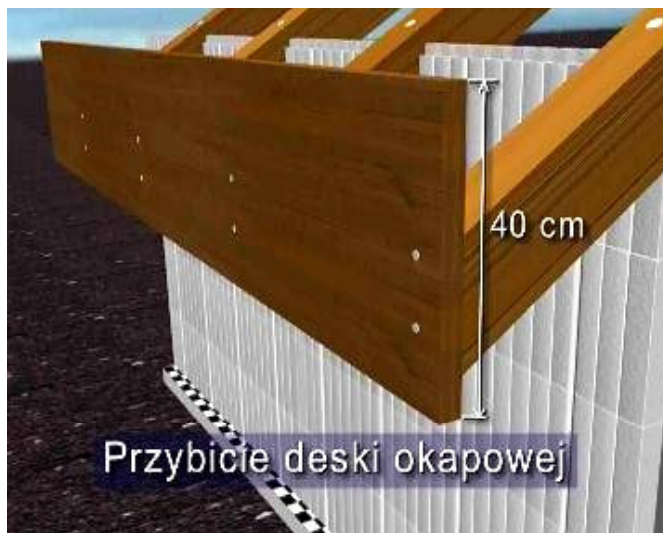
Rys.69 Montaż deski okapowej
