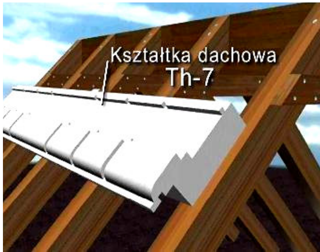
Rys.59 Układanie elementów dachowych TH-7
