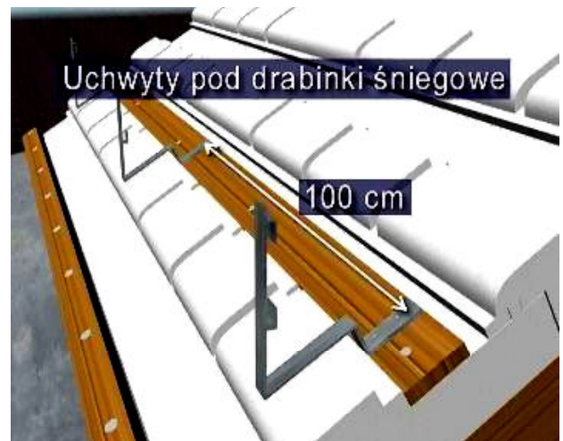
Rys. 74 Montaż uchwyty pod drabinki śniegowe
