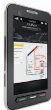
► Rys. 4. System monitoringu pracy instalacji solarnych i pomp ciepła Hewalex EKONTROL pozwala na szeroki zakres zdalnej obsługi i kontroli pracy urządzeń
