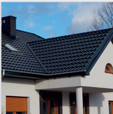
Plannja, Blachodachówka Flex . Masa [1 m 2 ]: 3,85. Materiał: stal ocynkowana, powlekana. Szerokość krycia/wymiary [mm]: 1185/1100. Kolorystyka: czarny, grafitowoszary, ceglasty, zielony, grafitowy metalik, grafitowy, wiśniowy, ceglasczerwony, brązowy. Gwarancja: 30 lat. Cena netto [zł/m 2 efektywny]: od 36,90.
