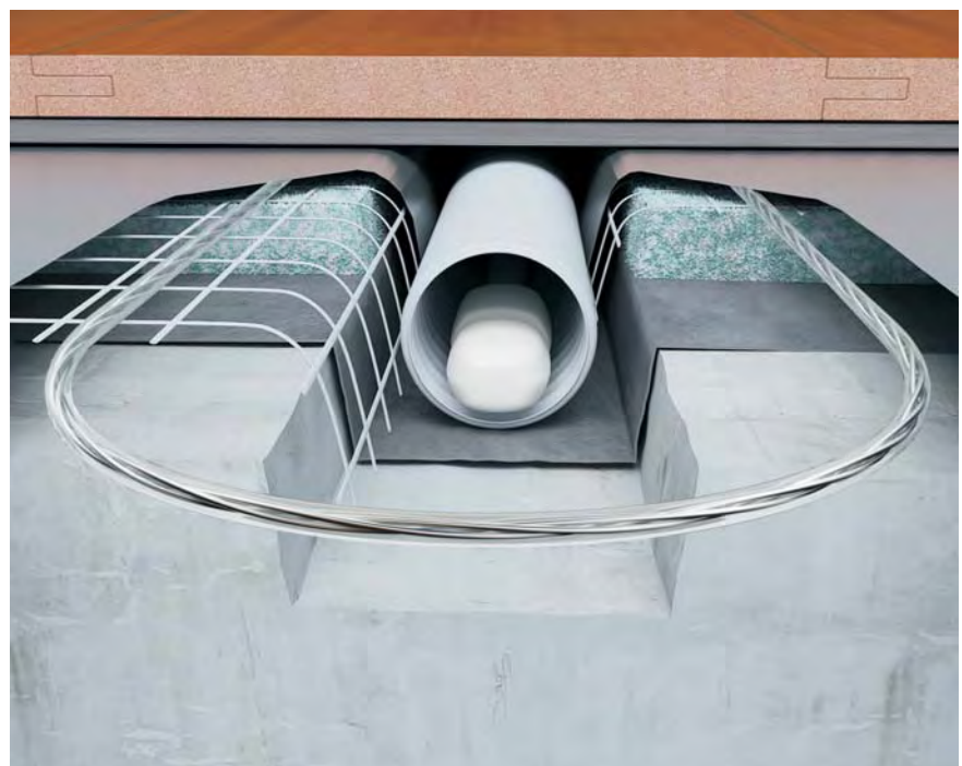
Sposób umieszczenia czujnika temperatury (bruzdę w posadzce należy wykonać na głębokość ok. 10÷12mm)
