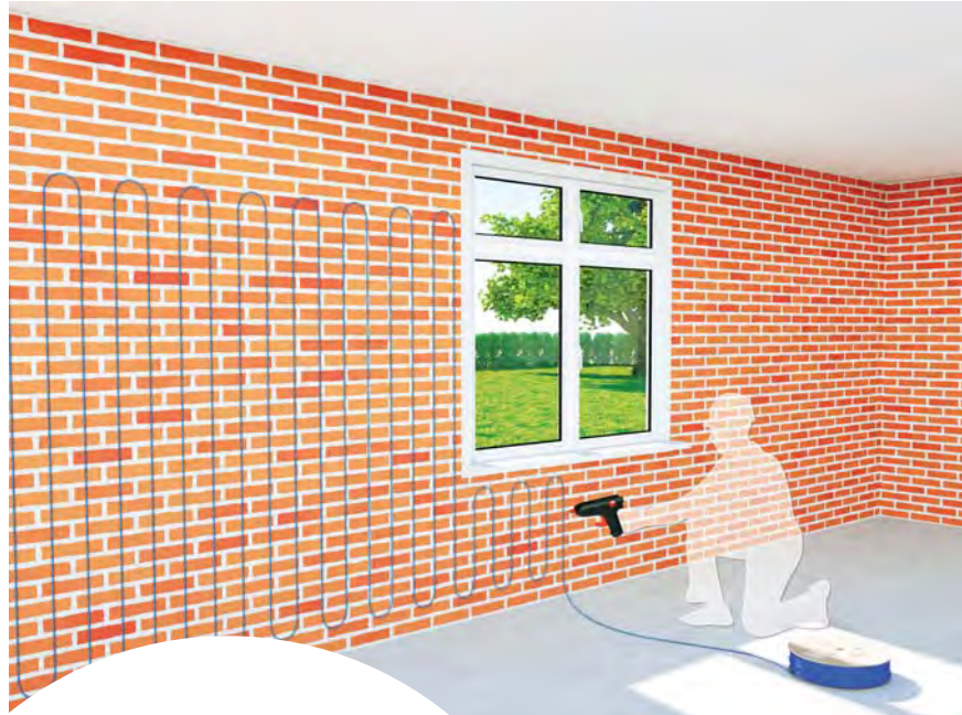
Mocowanie przewodu grzejnego ELEKTRA za pomocą kleju na gorąco
