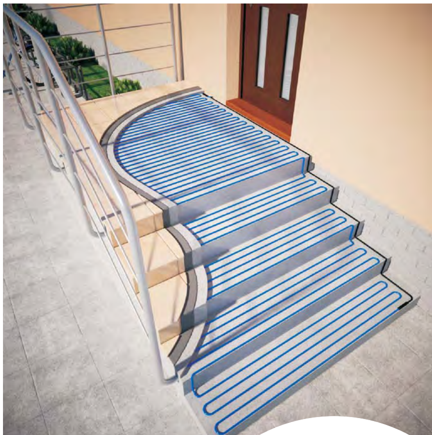
Ułożenie przewodów grzejnych dwustronnie zasilanych ELEKTRA VC20
