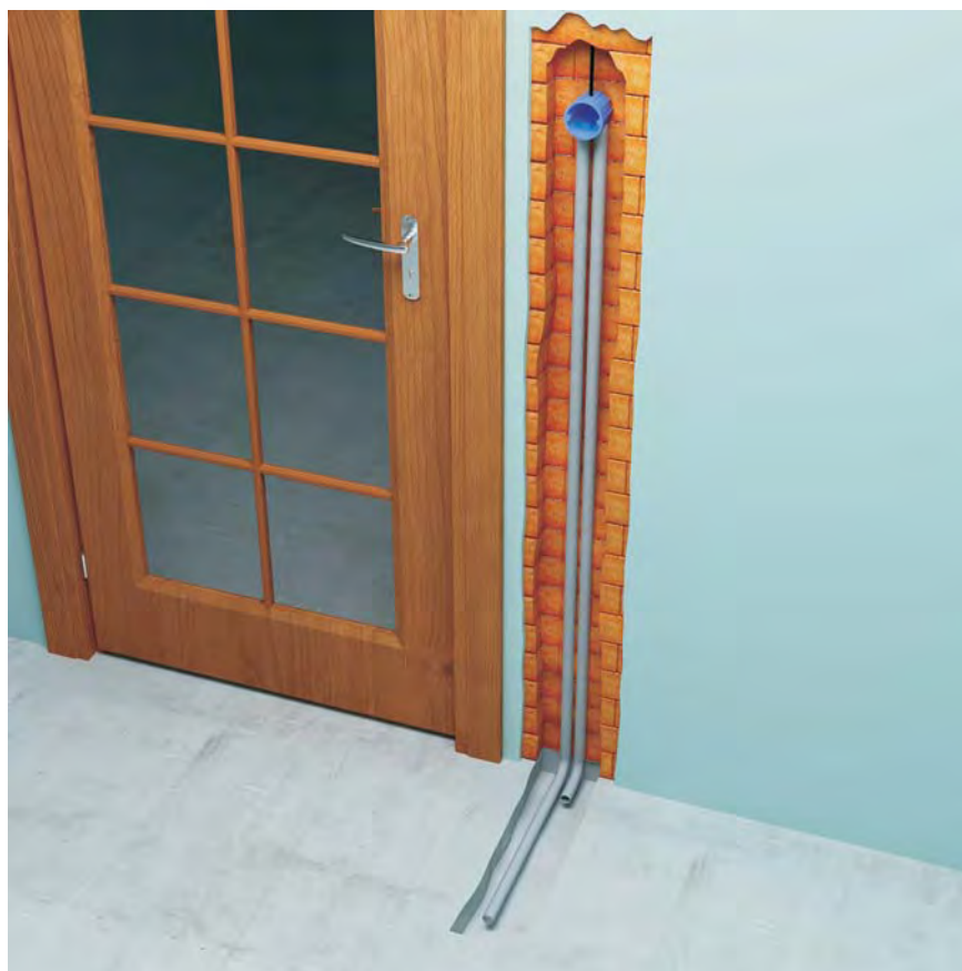
Instalacja rurek ochronnych
