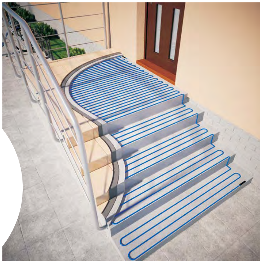
Ułożenie przewodów grzejnych jednostronnie zasilanych ELEKTRA VCD25
